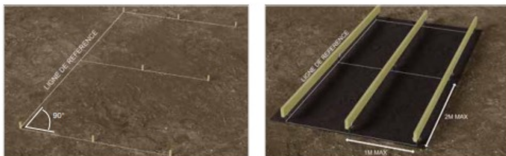
Exemple pour structure croisée en bois avec solives 45 x 145 mm et lambourdes 45 x 70 mm
