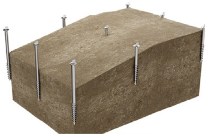
Etape 1 : installation des vis de fondation
