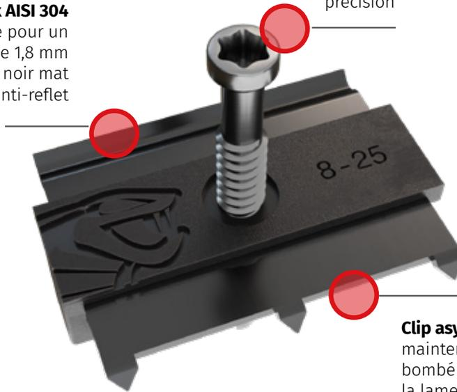
**Clip asymétrique :** Un côté griffes pour maintenir la lame fermement, un côté bombé qui facilite le positionnement de la lame suivante et permet la dilatation du bois
