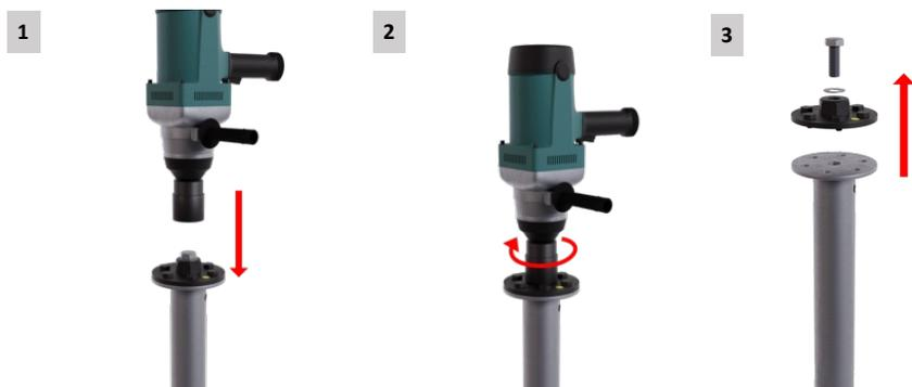
(1) Avec l'usage d'une boulonneuse à chocs, l'adaptateur M41 est requis. Soumis à des vibrations et un stress important lors du forage, il doit être assemblé avec un couple de serrage suffisant. Il est donc fortement recommandé d'utiliser une visseuse à chocs pour bloquer fermement l'écrou central de serrage.
